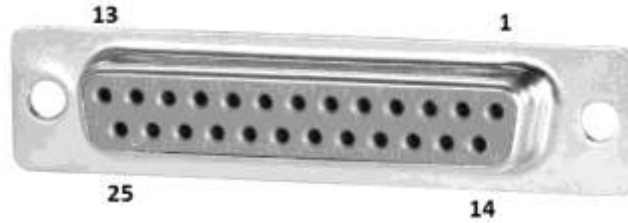
Şekil- DB25S Bağlayıcının önden görünüşü ve uç numaraları
