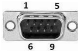
Şekil- DB9P Bağlayıcının önden görünüşü ve uç numaraları
