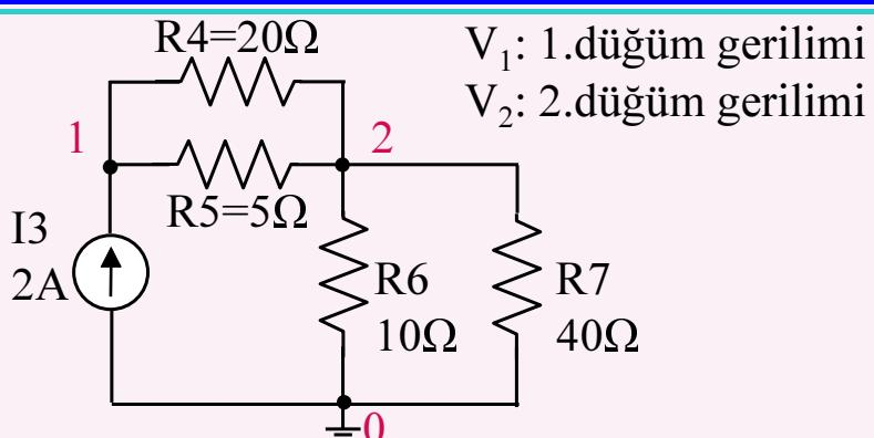
Eğer  $V_1$  ve  $V_2$  düğüm gerilimleri elde edilirse bütün dirençlerin akımları hesaplanabilir.
