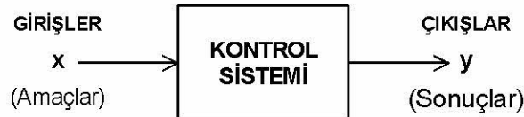
Şekil 1-1 Bir Otomatik Kontrol Sisteminin Blok Diyagramı
